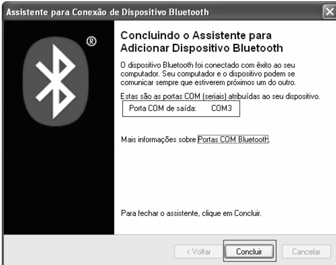
A primeira parte da instalação está concluída, anote a porta de saída do dispositivo. Na figura exemplo a porta de saída é COM3.
