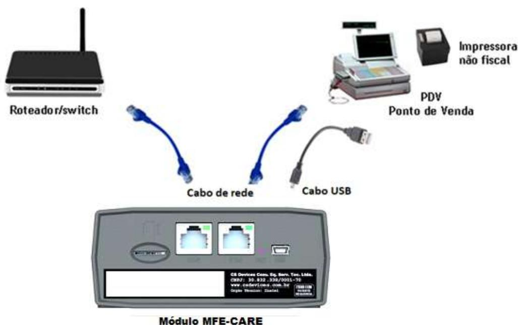
**Figura 14 – MFE-CARE instalado fisicamente com todos os cabos**
