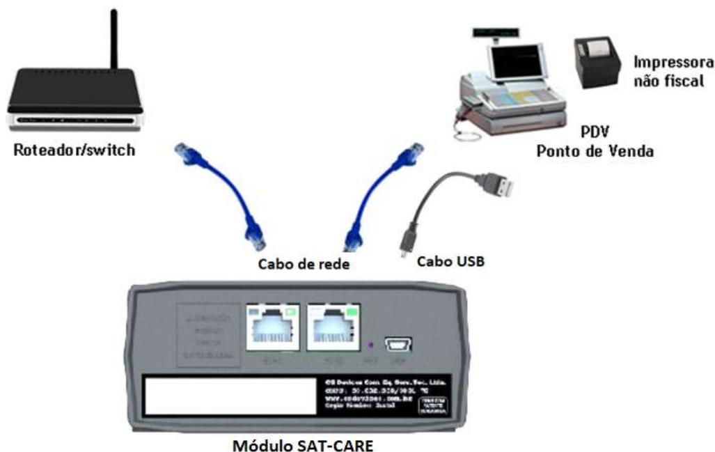
**Figura 18 – SAT-CARE instalado fisicamente com todos os cabos**
