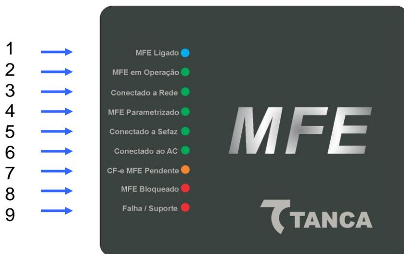
1 – **“MFE Ligado”** – Este dispositivo visual na cor azul indica que o TM-1000 está ligado a sua fonte de energia, no caso através do cabo USB.
